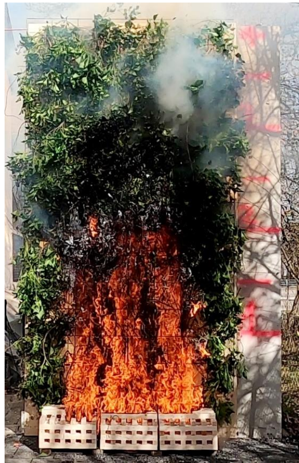
Abbildung 5: Fotodokumentation des Brandversuchs Test 3 mit Holz- und Grünfassade zur 3. Prüfminute
