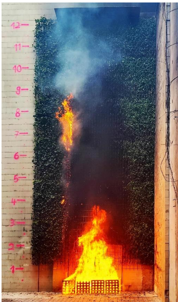
Abbildung 7: Foto des abschließenden Großbrandversuchs V1 des Forschungsvorhabens FireSafeGreen mit der 12 m hohen flächigen Anordnung und vitalen Kletterpflanzen
